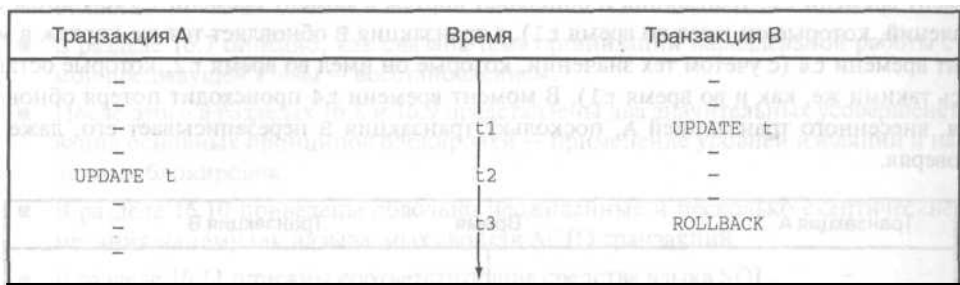
Рис. 16.3. Пример того, что транзакция А обновляет незафиксированное изменение в момент времени t2 и теряет это обновление в момент времени t3
