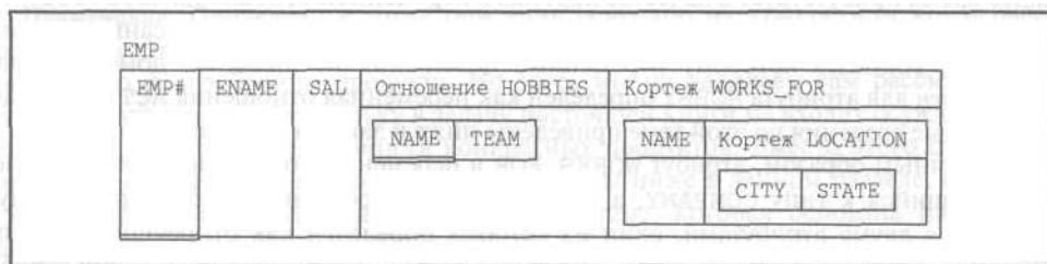
Рис. 26.2. Атрибуты, содержащие множества кортежей (указателей на кортежи), — нерекомендуемый вариант
